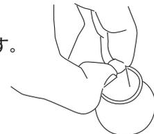
《3》アダプタを圧入したブーツホルダを取付けます。
