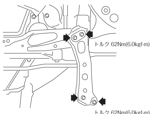
**注意** 本製品は締結時に変形することで締結力を高めています。再使用は絶対に行わないで下さい。また装着後、定期的に締付トルクを確認してください。
