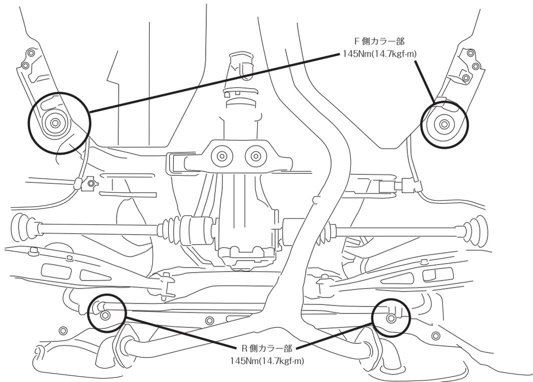
《2》ボルトを1本ずつ抜き取り、各カラーを挿入します。
