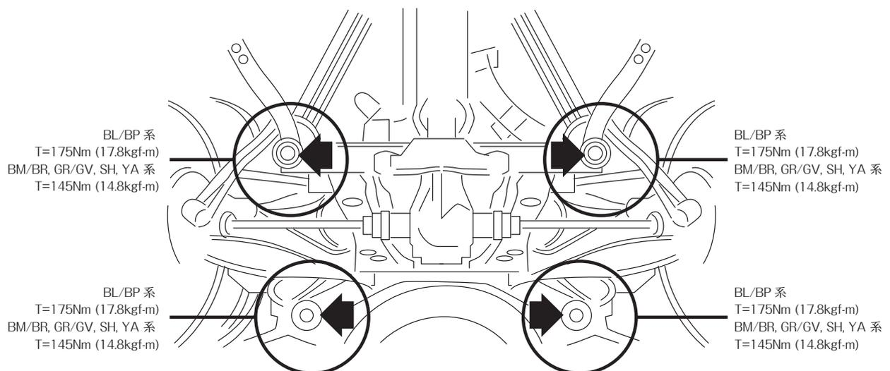
《2》 ボルトを1本ずつ抜き取り、カラーを取り付けます。
